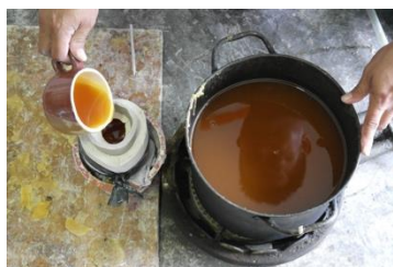
Rajah 9. Proses penuangan cecair campuran lilin dan damar dalam piece mould bagi mendapatkan model arca lilin
