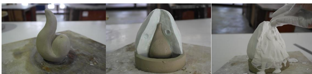
Rajah 8. Proses pembuatan piece mould menggunakan bahan serbuk plaster of paris dan air
