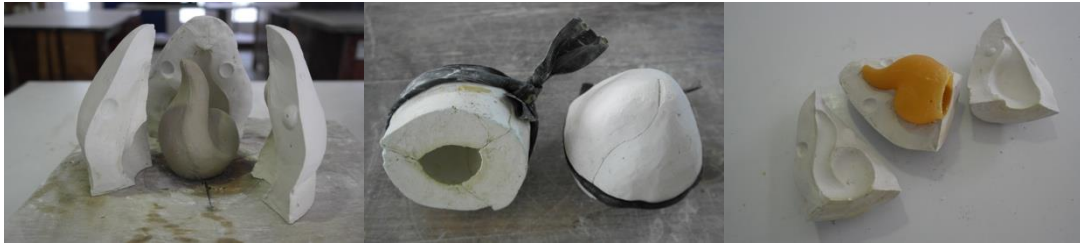
Rajah 10. Hasil pembuatan acuan piece mould dengan menggunakan sukatan formula baru bagi serbuk plaster of paris dan air (Formula : 100 ml air dan 125 g plaster of paris)
