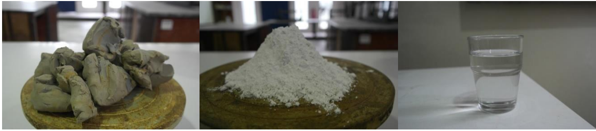
Rajah 3. Bahan material pembuatan acuan piece mould : tanah liat, serbuk plaster of paris dan air (Sumber : Gambar diambil oleh penulis)
