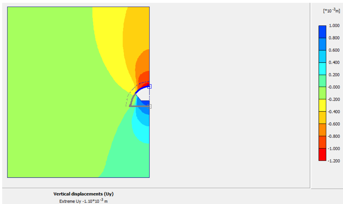
Fig 1.7 (d) Vertical displacement excavation at 2.0D
